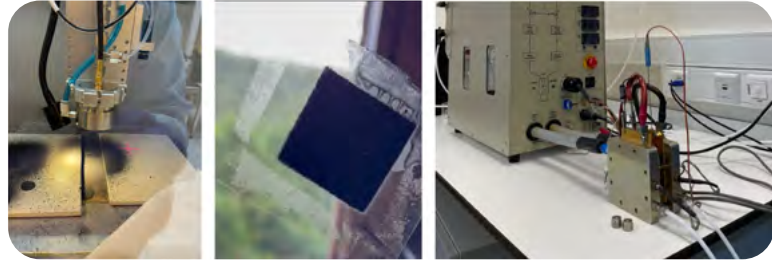
Şekil 2: PEM yakıt pili geliştirme süreci: katalizör tabakasının kaplanması, membran-elektrot yığını (MEA) hazırlanması ve tek hücre test konfigürasyonu.
