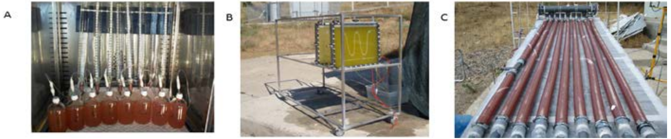
Şekil 8. HYVOLUTION Projesi esnasında geliştirilen fotobiyoreaktörler: (A) Küçük ölçekli laboratuvar denemeleri 55 mL'lik cam reaktörlerde soğutmalı inkübatörlerde yapıldı. (B) Açık hava denemelerinde içten soğutmalı panel fotoreaktörlerde (4 L) 3 aya varan sürekli hidrojen üretimi gerçekleştirildi, (C) Açık havada içten soğutmalı sirkülasyonlu 90 L'lik borusal fotobiyoreaktörlerle yüksek verim elde edildi [4].
