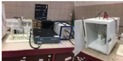
Potensiyostat, yakıt geçirgenlik ve proton iletkenlik ölçüm sistemleri
